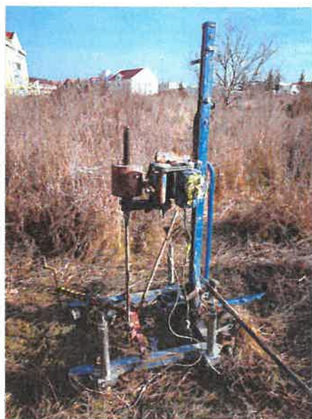
Foto 2: Aspectul terenului investigat și instalația de sondă de penetrare PDM utilizată.
